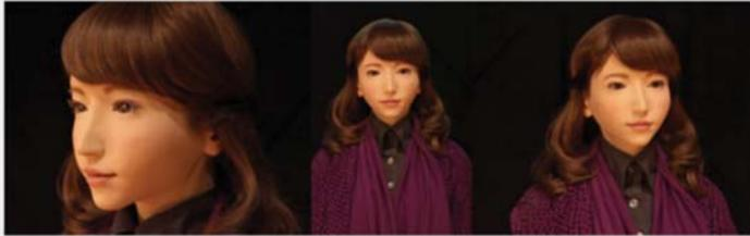
「ERICA (エリカ)」は、音声認識を用いて人間と自然に対話するアンドロイドの研究開発プラットフォームです。「ERICA (エリカ)」には、現時点で可能な音声認識、音声合成、動作認識、動作生成の技術が実装されており、変形は、美人に見られる多くの特徴を参考に、コンピュータグラフィックスで合成されています。また、音声も現時点で最も完成度の高い技術を基にして作られています。
