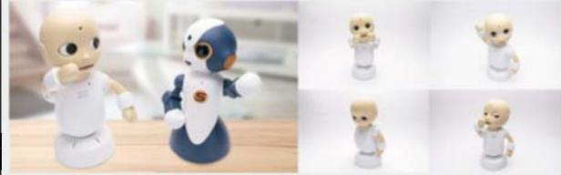
「CommU (コミュウ)」は、複数のロボット同士の対話を人間に見せることを、より高度な対話感を実現するために利用した、新しい形態の対話ロボットです。「CommU (コミュウ)」は、小型のロボットでは通常採用されない、眼球部、顔部、胴体部からなる豊富な自由度の機構を用いて視線方向を多様な方法で表現できる機能を備えており、これらの自由度の使い分けにより、人間に似た微妙な“社会的振る舞い”を実現することができます。
